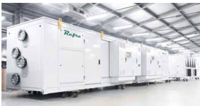
Tepelná čerpadla s propanem v továrně Refra
