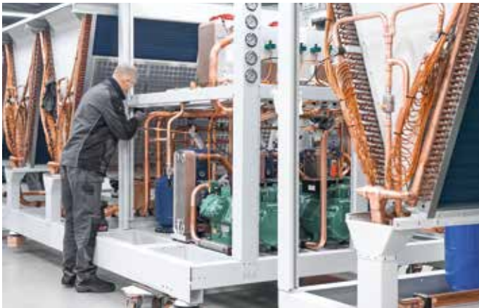
Teplná čerpadla s propanem jako chladivem v továrně Refra
