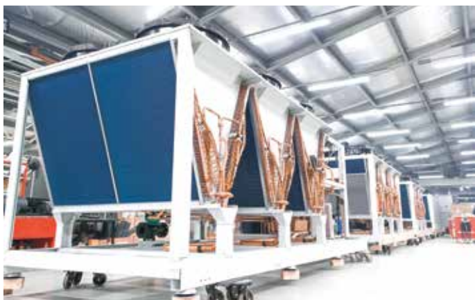
Tepelná čerpadla s propanem v továrně Refra.
